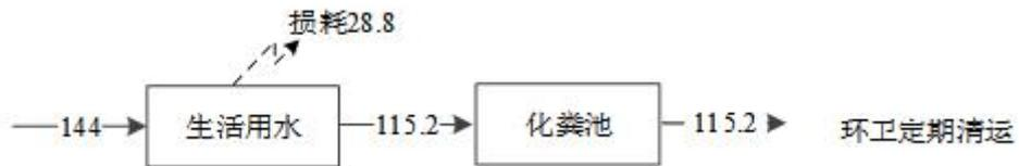
**项目水平衡图** 单位  $\text{m}^3/\text{a}$
